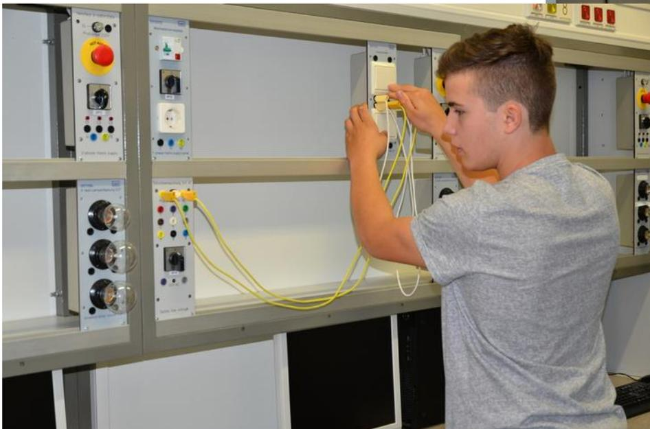
Installationsübung – Wechselschaltung umgesetzt mit zwei Kreuzschaltern!
