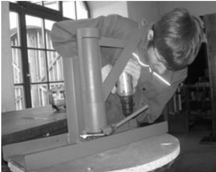
Dosenpresse in Bau (Foto A. Simmel)
