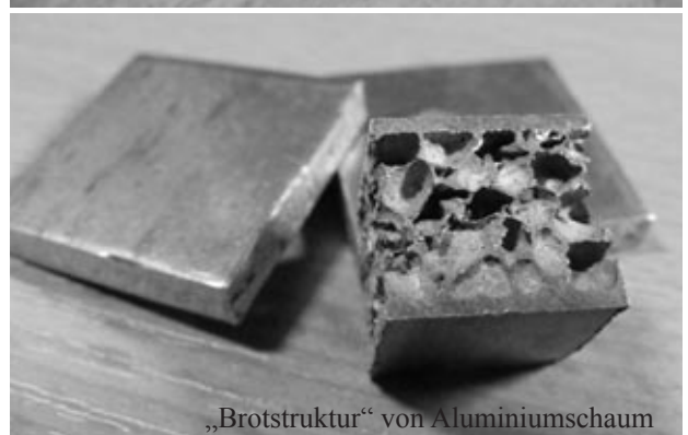
Aluminiumschaum vor und nach dem Backen
